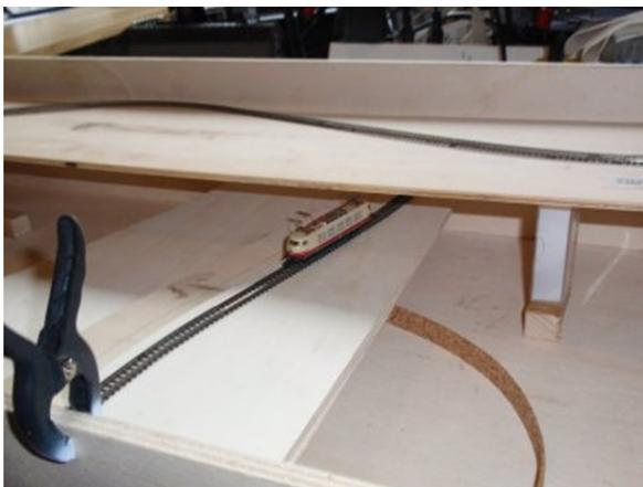
Unter die Gleise kommt ein Korkstreifen als Bettung und um etwas Schalldämmung zu erreichen.
